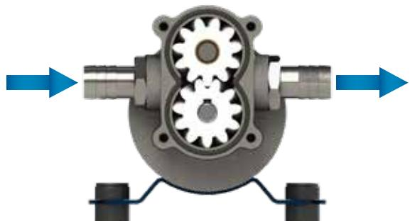
**IT** Elettropompe autoadescanti ad ingranaggi elicoidali in PTFE per travaso acqua e liquidi a bassa viscosità. Gli ingranaggi in PTFE garantiscono pressione costante, cicli di lavoro prolungati, maggiore silenziosità e ottima resistenza ad agenti chimici. Corpo in ottone nichelato, albero in acciaio inossidabile e tenuta in FKM se non diversamente specificato. Disponibili in versioni con filtro in linea, valvola di non ritorno.
