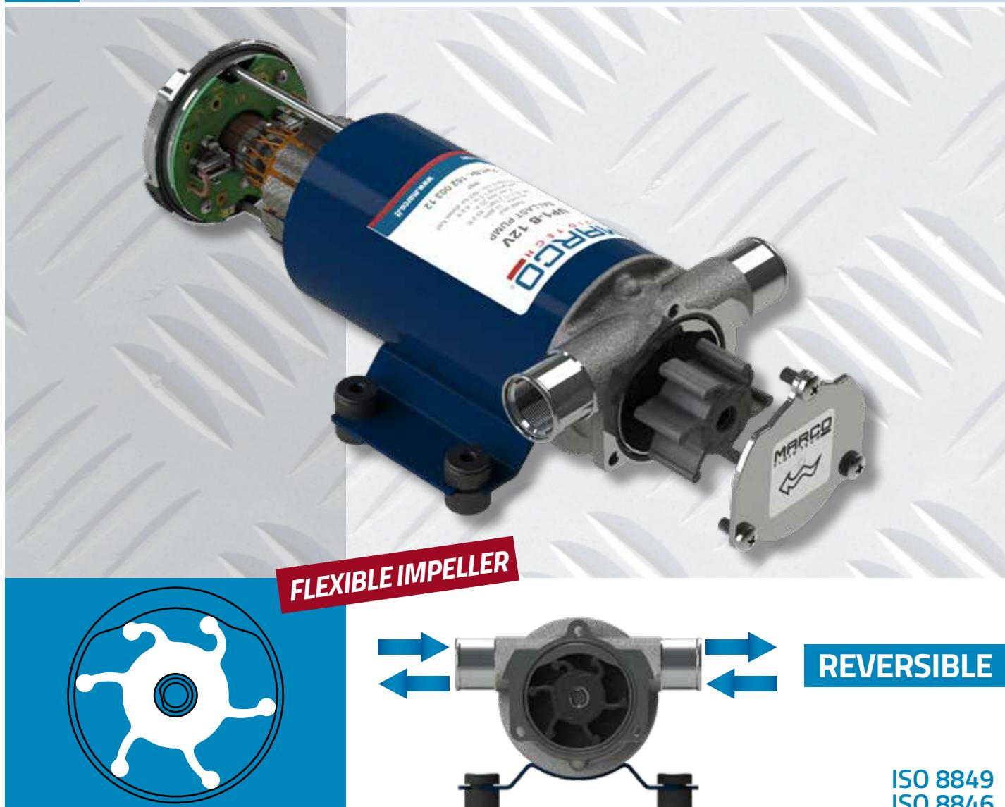
**IT** Elettropompe autoadesanti con girante flessibile in gomma. La girante in gomma garantisce alta portata e permette il passaggio di piccole impurità contenute nelle acque grigie. Disponibili con portate da 28 l/min a 45 l/min e in versioni con interruttore o deviatore integrati. Dotate di portaspazzole interno con filtro antidisturbo EMI, calotta impermeabile e passacavo stagno. Corpo in ottone nichelato, albero in acciaio inossidabile. Tenute in FKM e O-ring in NBR. ISO 8849 e ISO 8846.
