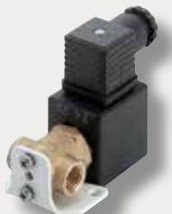
**IT** Elettrovalvola per impiego acqua su imbarcazioni. Bocche da 1/4". Pressione max. 5 bar. Corpo in ottone, canotto interno in acciaio inox. Applicazioni: sistema impianto tergilustranti, sistema di erogazione acqua per imbarcazioni.
